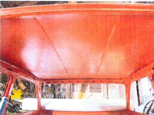
Gereinigt, entrostet, neu lackiert. Die beiden Sicken im Dach dienen zur Versteifung und sollen Dröhngeräusche mindern
