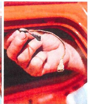
Kabel von Innenleuchte, heizbarer Heckscheibe und Ähnlichem jetzt checken – später sind sie wieder unerreichbar
