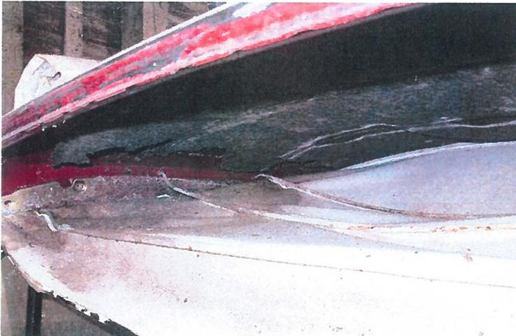
Durch die C-Säule fand eine Mäusekolonie den Weg unter den Himmel. Für den Nestbau wurde die Dämmplatte verwendet, Spriegel und Klemmbleche sind durch Urin korrodiert
