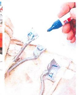
Die gezahnten Klemmbleche und die Spriegel waren derart verrostet, dass wir intakte Gebrauchtteile besorgt haben. Vergleichstest: Der neue Himmel wird (mit der Rückseite) auf das Altteil gelegt, die Position der Spriegel markiert
