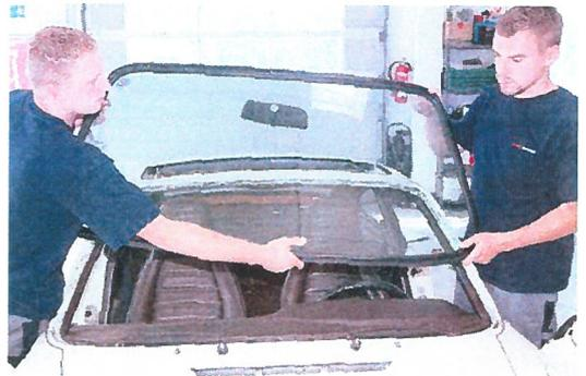
Bei nahezu jedem Fahrzeug müssen die Scheiben demontiert werden. Kalkulieren Sie eventuelle Rost-Reparaturen mit ein
