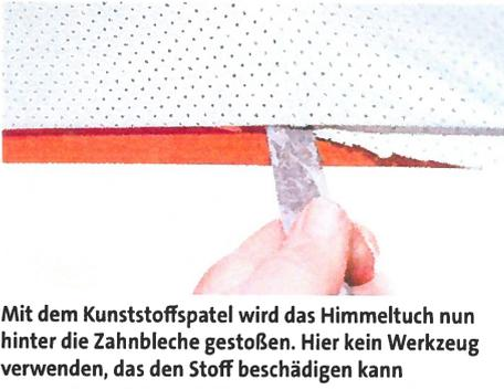
Mit dem Kunststoffspatel wird das Himmeltuch nun hinter die Zahnleche gestoßen. Hier kein Werkzeug verwenden, das den Stoff beschädigen kann
