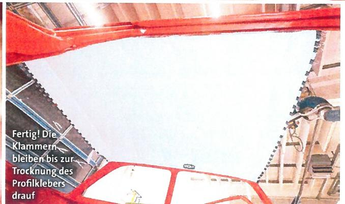
Fertig! Die Klammern bleiben bis zur Trocknung des Profilklebers drauf
