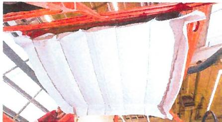
Sieht aus wie ein Baldachin, ist aber erstmal korrekt: Der Himmel hängt, der seitliche Materialüberstand ist rundum gleich. Die Falten werden verschwinden
