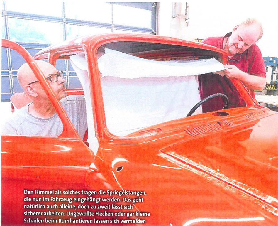
Den Himmel als solches tragen die Spriegelstangen, die nun im Fahrzeug eingehängt werden. Das geht natürlich auch alleine, doch zu zweit lässt sich sicherer arbeiten. Ungewollte Flecken oder gar kleine Schäden beim Rumhantieren lassen sich vermeiden
